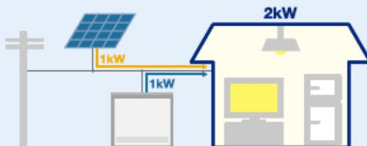
ご家庭でご使用の電気が2kW、太陽光が1kW発電している場合、太陽光で発電された電気は1kWをご家庭の電気に供給し、エネハンド蓄電池より不足分の1kWを放電いたします。
